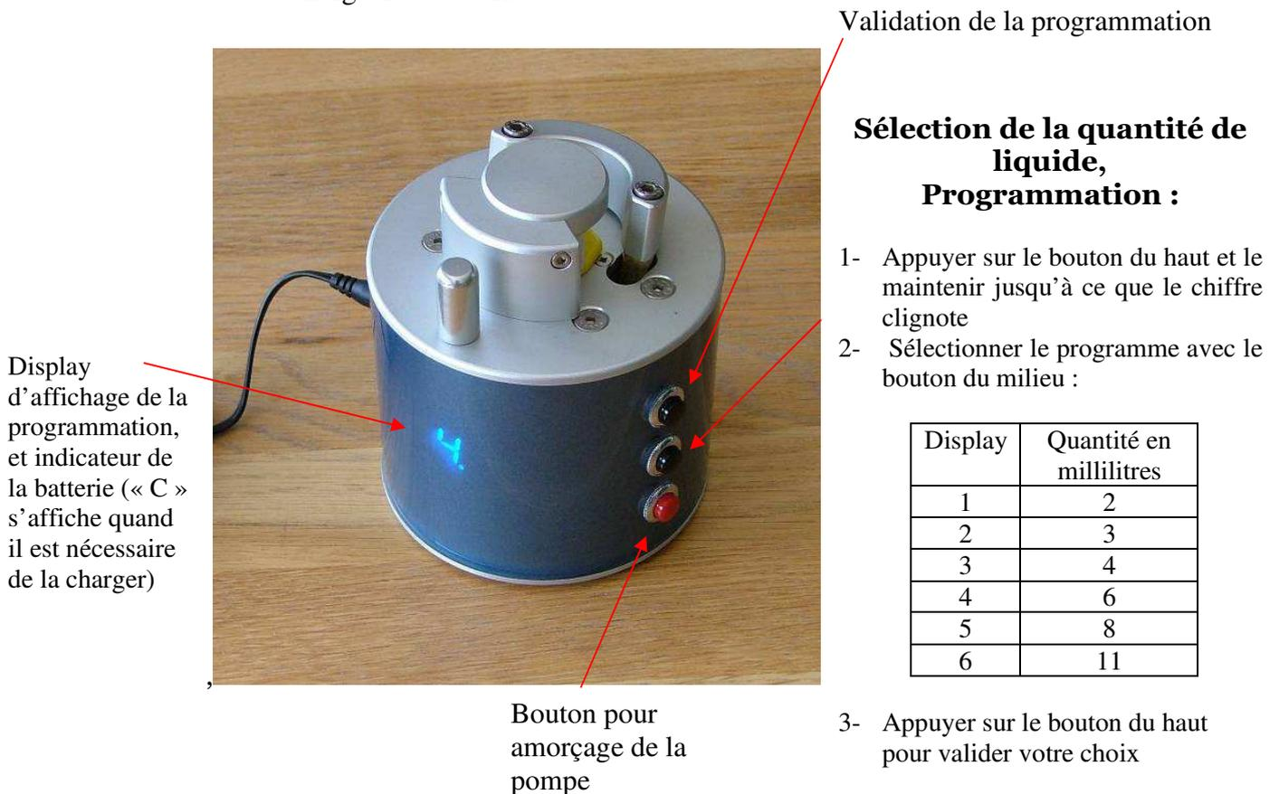
**Amorçage de la pompe :** Pour remplir le tuyau de liquide au démarrage
