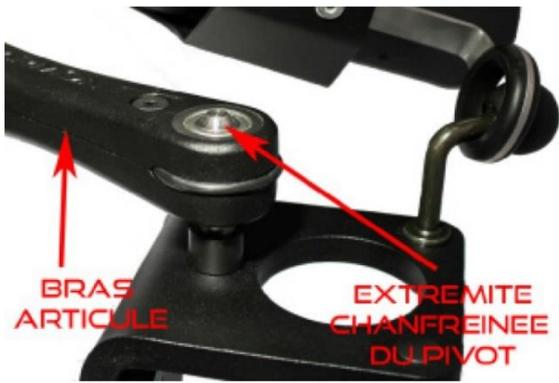
**ATTENTION !** Veiller à ce que la goupille traverse tous les segments articulés. L'extrémité supérieure chanfreinée de la goupille doit ressortir des segments articulés, comme indiqué sur l'image de gauche. Si ce n'est pas le cas, les roulements peuvent être endommagés.
