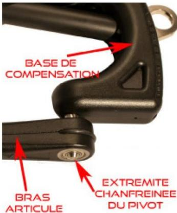
**ATTENTION !** Veiller à ce que la goupille traverse tous les segments articulés. L'extrémité inférieure chanfreinée de la goupille doit ressortir sous les segments articulés, comme indiqué sur l'image de droite. Si ce n'est pas le cas, les roulements peuvent être endommagés.
